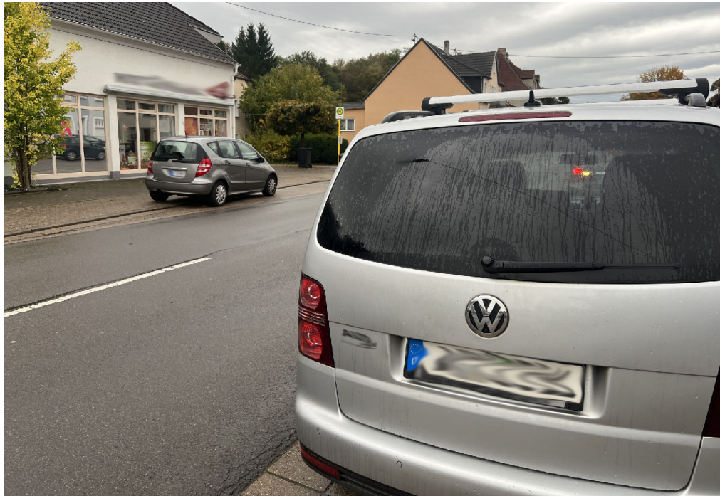
Abb. 13: Der Parkstreifen ist nicht nur im Bereich der geplanten Zufahrt zu entfernen, sondern auch jeweils ca. 15m davor und danach, um die Sichtbehinderung durch parkende Fahrzeuge zu vermeiden.
